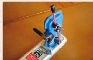
③ レバー付き手動柿むき器。手前のレバーを動かすと、皮をむいた後の柿が自動ではずれる仕組みになっている。
