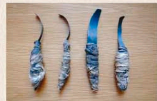
① 千重。柿の表面に沿うように刃先が曲がっているのが特徴。
