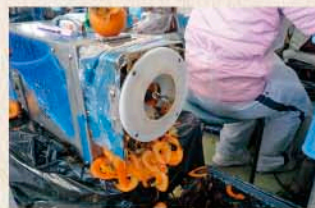
⑥ 吸引式全自動柿むき機。ヘタ処理機(写真左)との併用が必要。衛生面、安全面からも画期的な最新柿むき機。
