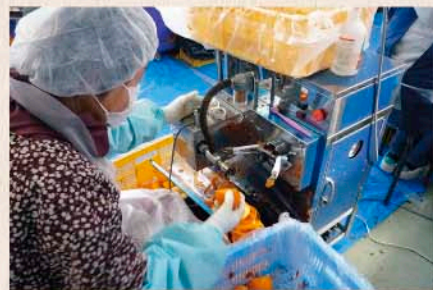
⑥ 吸引式全自動柿むき機。ヘタ処理機(写真左)との併用が必要。衛生面、安全面からも画期的な最新柿むき機。
