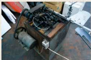
④ 北原利雄が発明した柿むき機第1号機。動力はモーター。皮をむいた後、ペダルを踏むと、柿が針から自動ではずれる仕組みになっている。
