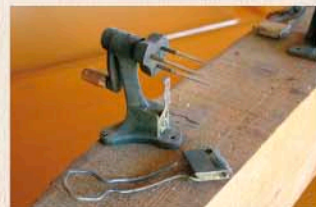
② 手動柿むき器。板に固定されていて両手で作業がしやすい。
