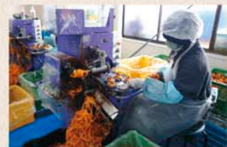
⑤ 全自動柿むき機「ムッキー」。柿を針で固定する仕組みは、手動柿むき機と同じ。作業の省力化に大きく貢献した。
